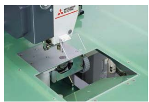
La canette peut être remplacée par le dessus.
